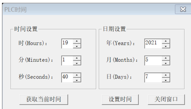
图2-18 设置 PLC 时间
